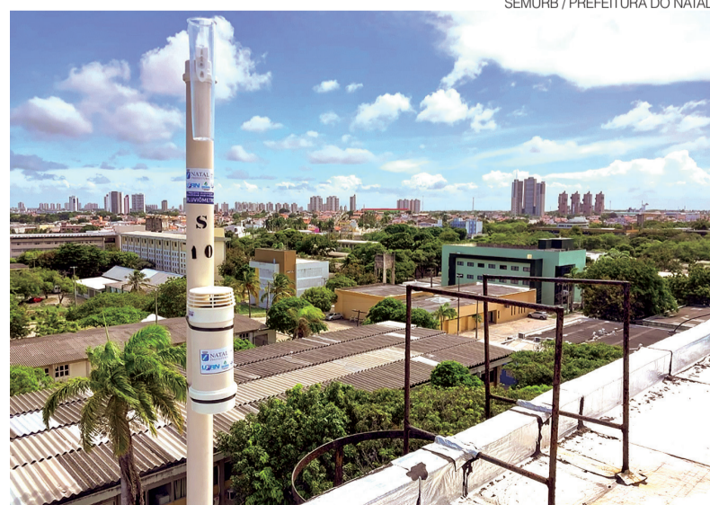
Pluviômetro instalado na UFRN integra rede de monitoramento climático
